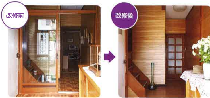
トイレルの面した玄関ホールには冷気を封じる防寒戸があり、冬は氷点下にもなる寒い場所でした。断熱改修後は、防寒戸が不要となり、ホールに広がり生まれ、バリアが解消しています。（※写真：勇和建設株式会社/札幌市）
